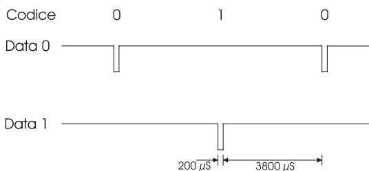
Figura 7 – Diagramma esempio dei segnali Wiegand
